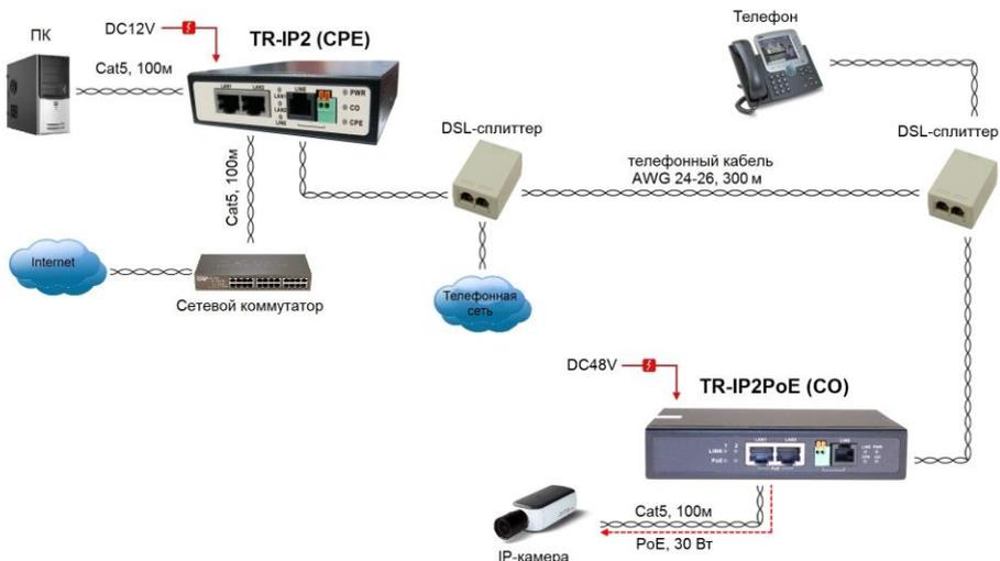
Рис. 7b Схема подключения TR-IP2PoE (CO) и TR-IP2 (CPE) для организации IP-видеонаблюдения с параллельным подключением телефонного аппарата
