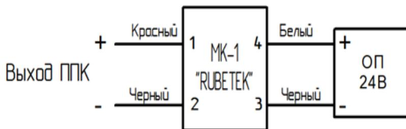
Рисунок 12 – Схема подключения МК-1 к ОП
