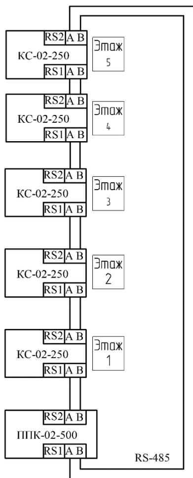
Рисунок 7 – Схема подключения контроллеров к ППК
