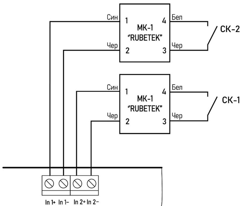
Рисунок 14 – Схема подключения свободно программируемых входов
