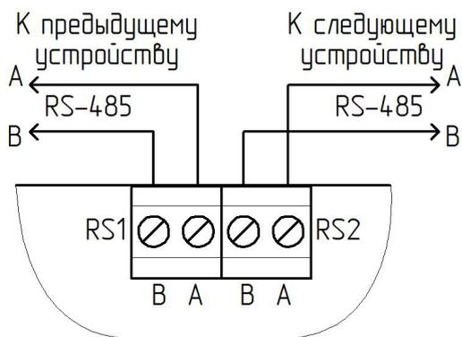
Рисунок 8 – Подключение RS-485
