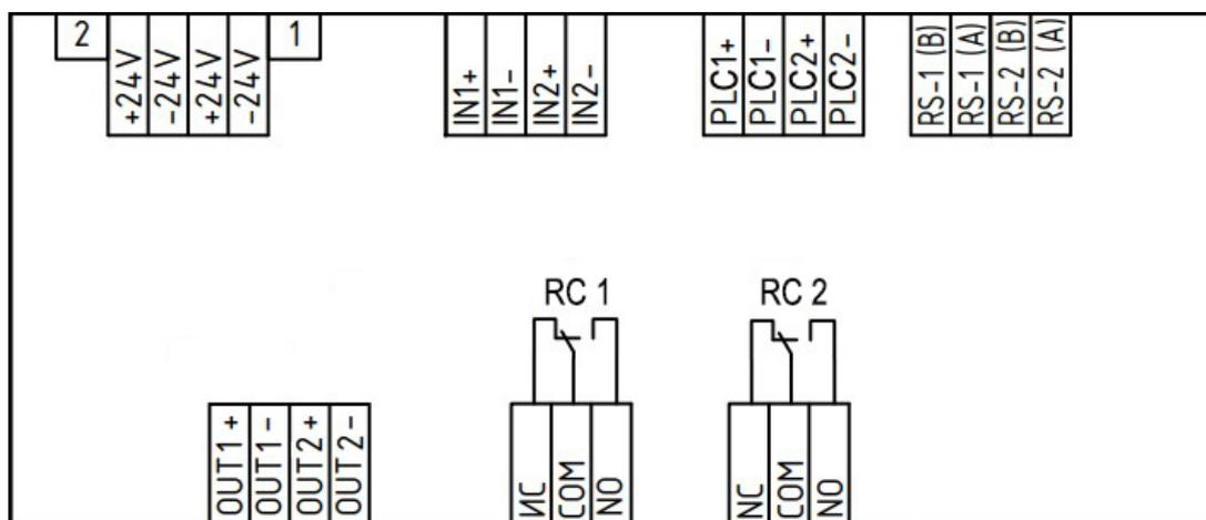
Рисунок 4 – Маркировка клемм контроллера
