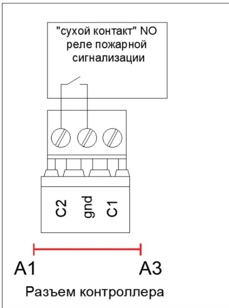
Для автоматической разблокировки замков дверей (турникетов) в случае возникновения пожарной тревоги, "нормально открытый" (NO) контакт реле интерфейса пожарной сигнализации подключить к контактам A1-A2 (A2-A3) платы контроллера.
