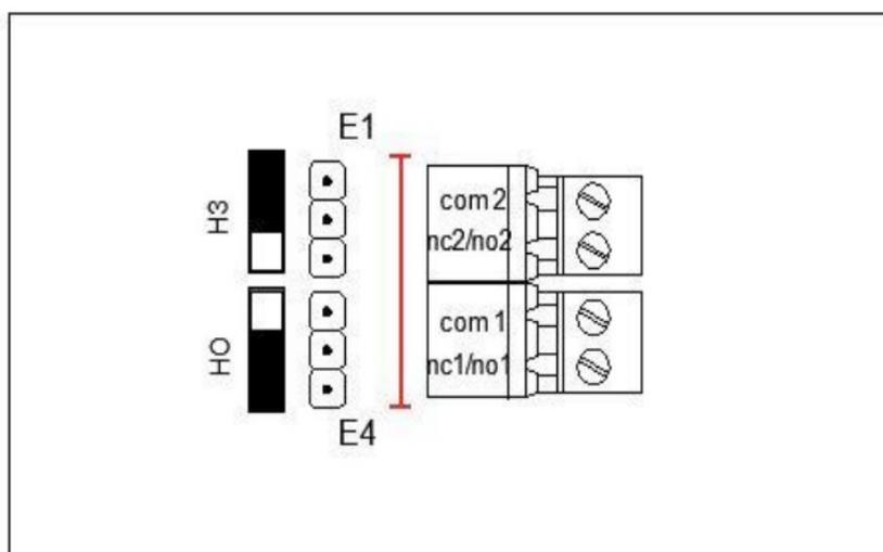
Перемычки используются для переключения состояния выходных контактов реле управления внешними устройствами из нормально открытого состояние в нормально закрытое и обратно.
