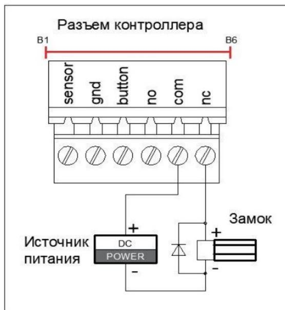
Схема подключения электромеханического замка:
