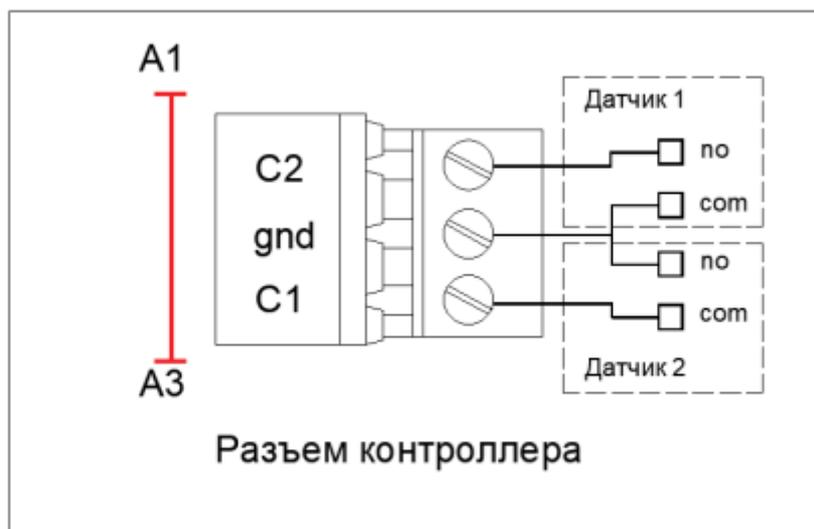
Контроллер имеет два внешних GPIO входа для подключения внешних датчиков. В качестве таких датчиков могут использоваться антикражные, антивандальные и т.п. устройства имеющие нормально открытый «сухой контакт» или уровень логического нуля при срабатывании. При изменении сигнала на GPIO входах, в ПО TRASSIR формируется событие «сигнал на входе появился/пропал».
