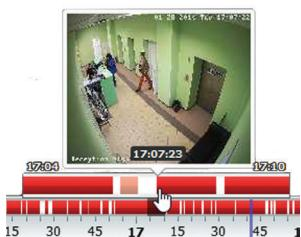
**Удобная навигация** - ускорение и удобство работы выросли на порядок, без дополнительной нагрузки на сервер. Область движения отмечена красным цветом, чем интенсивней движение, тем более насыщен красный цвет. При наведении на интересующий участок всплывает окно предпросмотра интересующей сцены.
