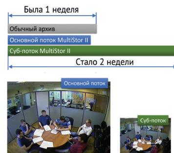
**EdgeStorage - двойная надежность** позволяет использовать два независимых архива в одной системе. Современные IP камеры, регистраторы и устройства Lanser поддерживают запись на встроенный жесткий диск или SD карту. TRASSIR может управлять каждым архивом по отдельности. В случае сбоя электропитания сервера или пропажи связи данные на устройстве не будут потеряны.
