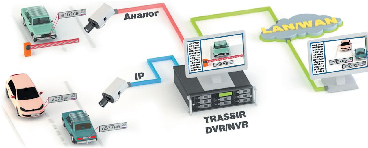
Автоматическое распознавание автомобильных номеров для контроля въезда / выезда автотранспорта с территории предприятий, парковок. Возможно использование службами автоинспекции, на пропускных пунктах и в других контрольных точках. Средствами TRASSIR обеспечивается взаимодействие с контролем доступа, видео- и аудиоконтроля и оборудованием (шлагбаумами, исполнительными устройствами, стационарными измерителями скорости движения ТС и пр.).
