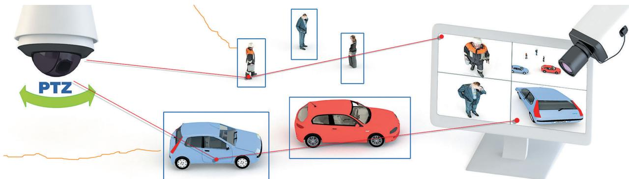
Оптическое увеличение движущихся объектов скоростными поворотными камерами в сочетании с обзорными дает эквивалент записи по детектору с камеры до трехсот Мегапикселей. Комбинируйте несколько обзорных камер для создания панорам, используйте несколько поворотных SpeedDome камер для одновременного сопровождения нескольких объектов.
