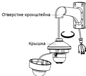
Рисунок 2-9 Установка крышки на кронштейн
