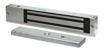
Электромагнитный замок ST-EL270L предназначен для запирания дверей, контролируемых СКУД, а также дверей эвакуационных выходов. Одноцветная световая индикация обеспечивает визуализацию различных состояний замка: СИД не горит – нет питания, красный сигнал – на замок подано питание. Для преодоления остаточной намагниченности в устройстве используется специальное цинковое покрытие якоря замка совместно с пружинным механизмом.
