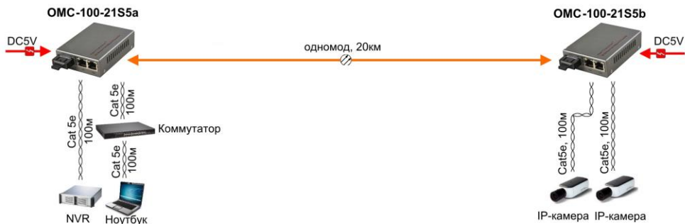
Рис. 7 Схема подключения медиаконвертеров OMC-100-21S5a (OMC-100-21S5b)
