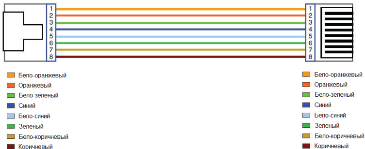
Рис. 8 Обжимка кабеля по типу TIA/EIA-568-A.
