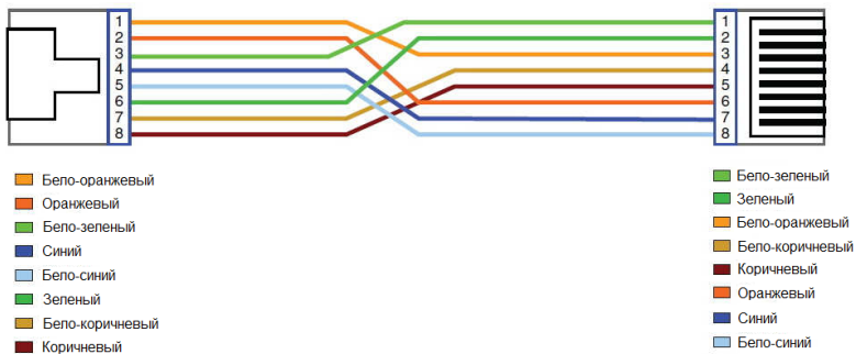
Рис. 9 Обжимка кабеля по типу TIA/EIA-568-B.
