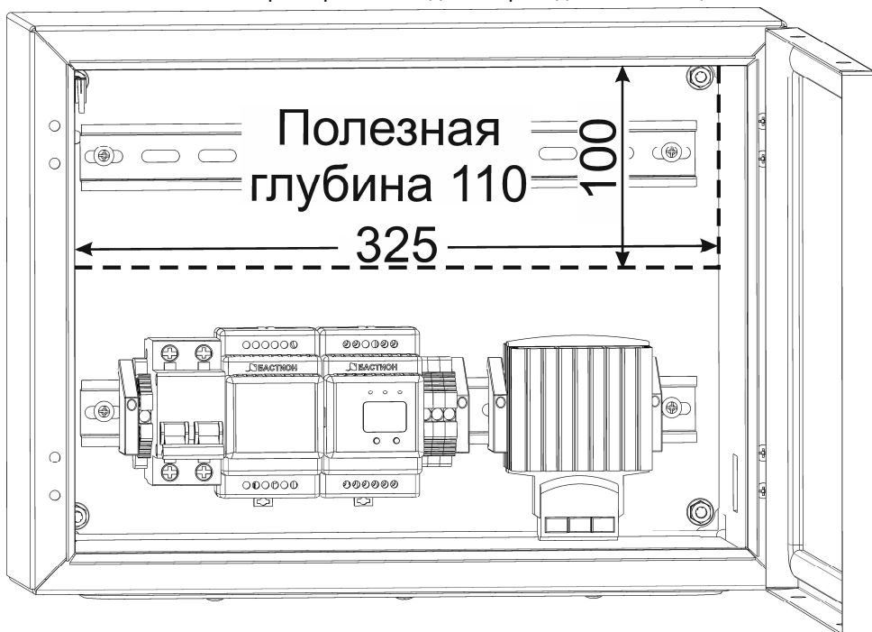
Рисунок 1 – Пространство внутри для установки доп. оборудования
