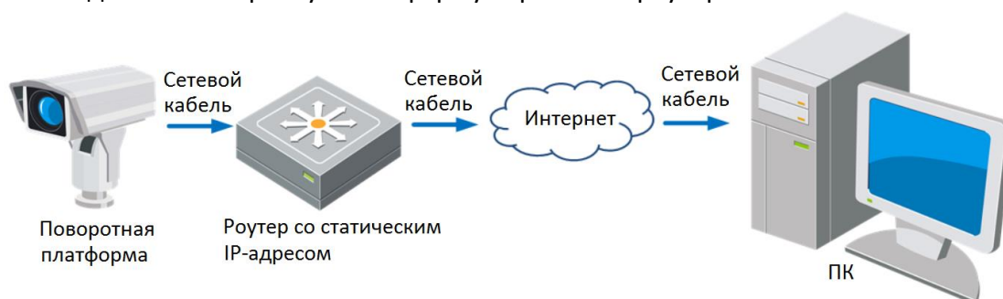
Рисунок 2-10 Доступ к поворотной платформе через роутер со статическим IP-адресом
