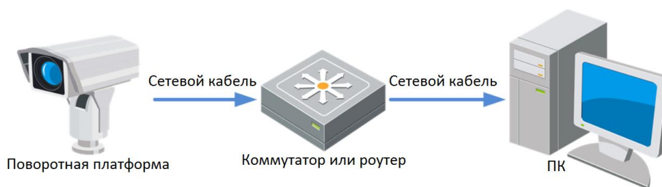
Рисунок 2-2 Подключение через коммутатор или роутер
