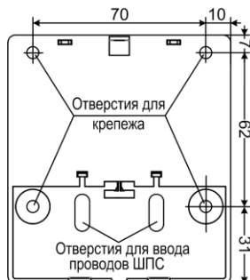
Рис.1 Задняя стенка. Расположение отверстий для крепежа, присоединительные размеры
