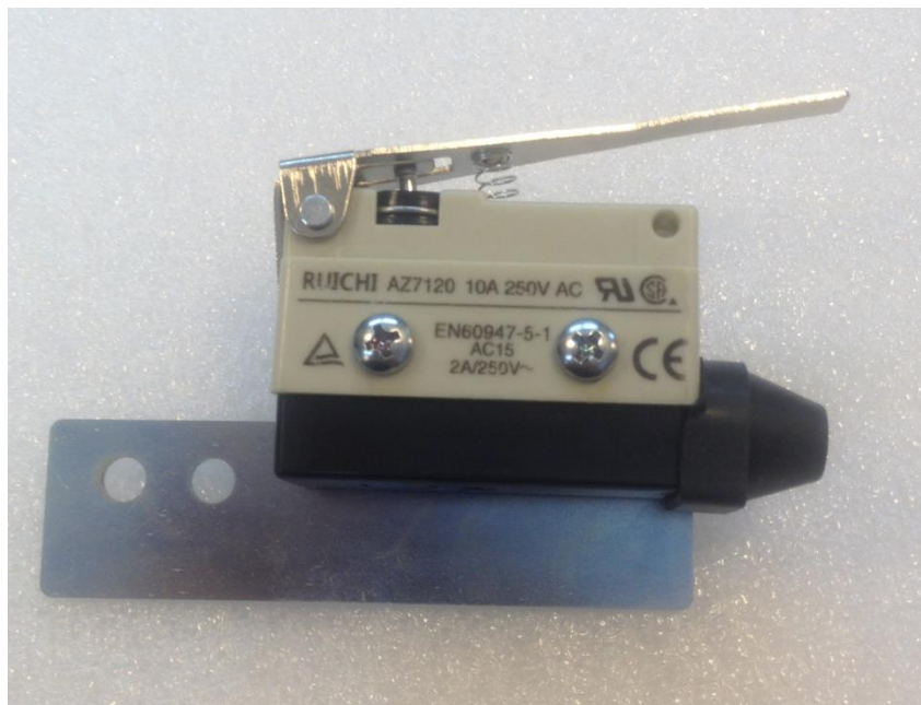
Рис.3.3.7-1 Присоединение датчика вскрытия к монтажной панели
