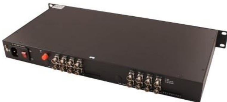
Рис.5 Передатчик TA-H16/1F / приемник RA-H16/1F, внешний вид
