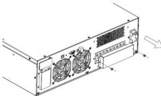
2) Подключите кабель аккумулятора к модулю питания и проверьте его полярность подключения.
