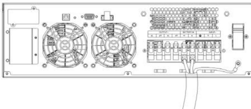
3) Ослабьте винты, чтобы снять крышку выходного разъема аккумуляторного модуля.
