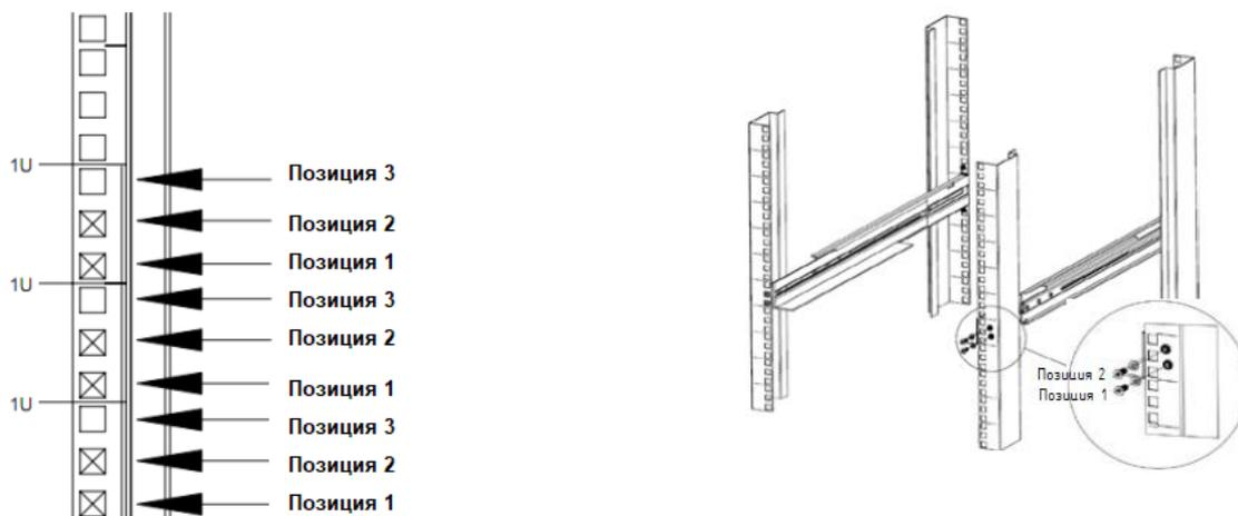
2) Прикрепите крепёж двумя винтами M5X12L, используйте две пластиковые шайбы и две гайки M5 для монтажа передней части. (в позициях 1 и 2; также можно установить в позициях 1 и 3 или в позициях 2 и 3). Не перетягивайте винты. Отрегулируйте крепёж. Закрепите крепёж в задней части при помощи двух винтов M5X12L, двух пластиковых шайб и двух гаек M5. Затяните все винты спереди и сзади. Повторите эти действия для установки остальных креплений.
