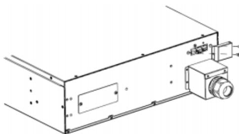
4) Подключите аккумуляторный кабель к аккумуляторному модулю. Установите на место и закрепите крышку клеммного блока винтами.
