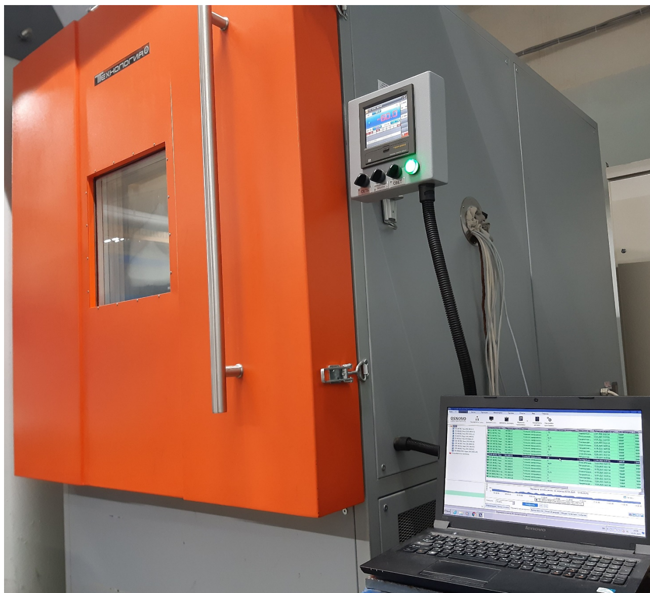
Рис.2 Испытательная камера КТХВ-500, ноутбук с программным обеспечением OSNOVO Monitoring System
