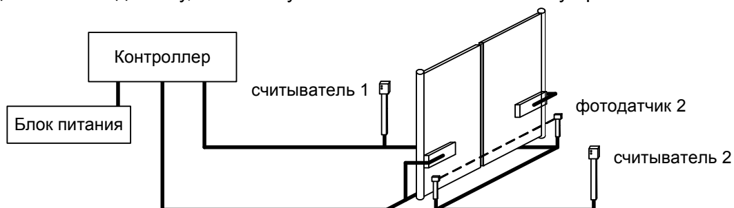
Рисунок 28. Пример автоматизации ворот с использованием карточек или меток.
