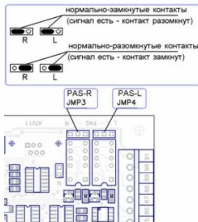
Рисунок 88. Перемычки JMP3 и JMP4 контроллера ОМА–DD.958, ОМА 264MC1, 866.MC2.
