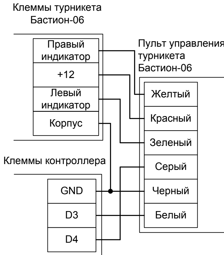
Рисунок 110. Первый вариант подключения пульта управления «Бастион-06» и «Бизон».
