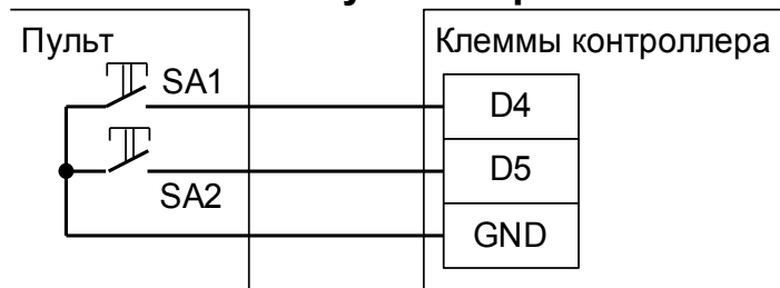
Рисунок 150. Пульт ручного управления шлагбаумом/воротами, кнопка «Стоп» нормально разомкнута.
