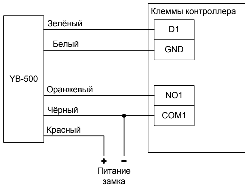
Рисунок 35. Пример подключения замка YB-500 для первой двери в конфигурации «Две двери».
