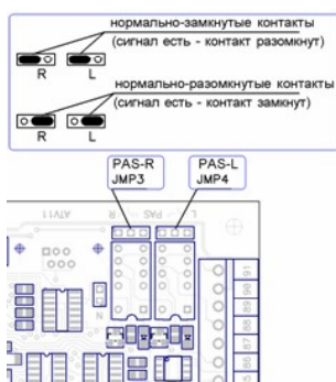
Рисунок 93. Перемычки JMP3 и JMP4 контроллера ОМА 264MC1.
