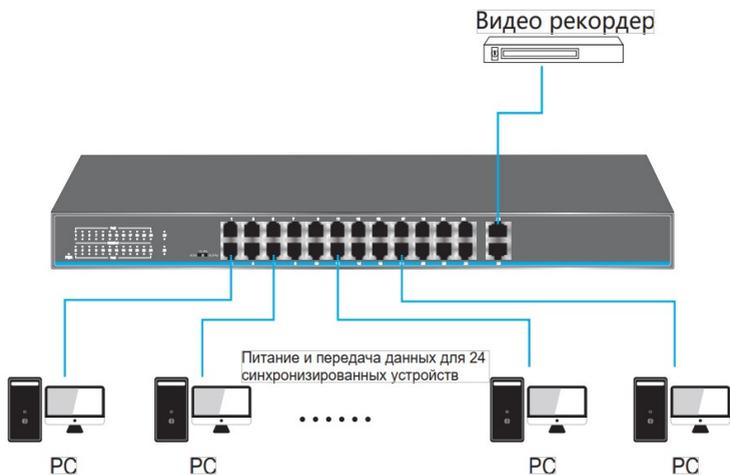
Рисунок 7 – Схема подключения устройств к коммутатору. Вариант 2.
