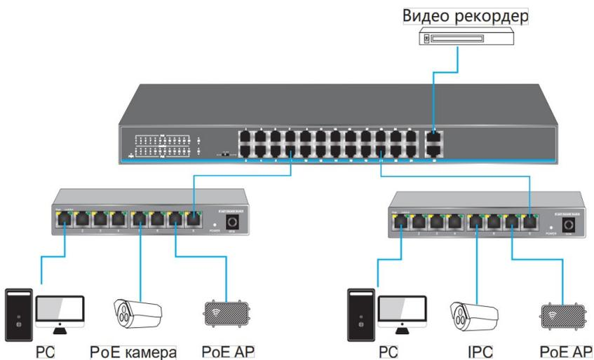
Рисунок 8 – Схема подключения устройств к коммутатору. Вариант 3.
