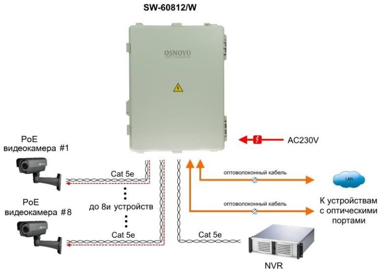
Рис.6 Типовая схема подключения коммутатора SW-60812/W
