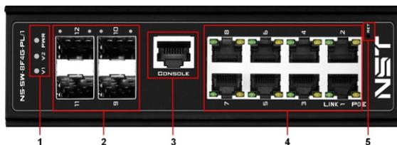
Рис.1 Разъемы и индикаторы на передней панели
