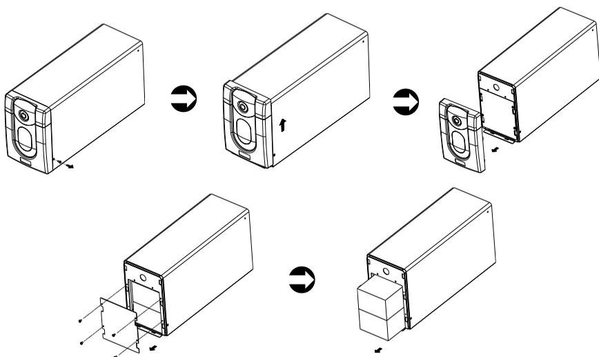
1. Вывинтите винты боковых креплений крышки батарейного отсека.
