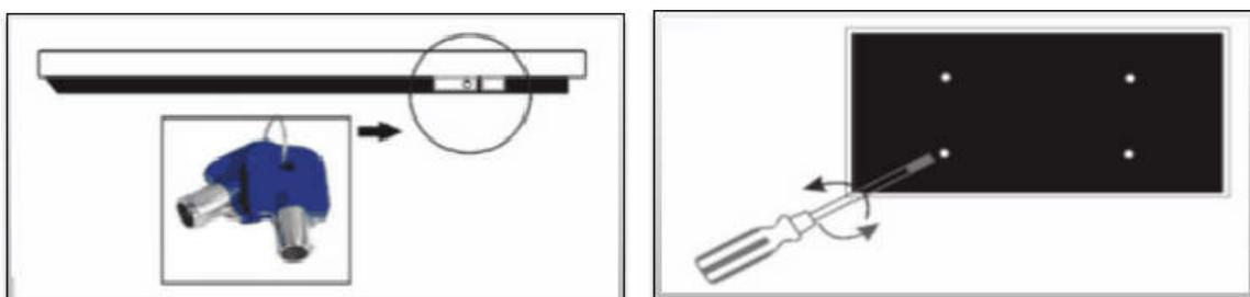
Шаг 2: Положите защитную подушку на экран устройства FaceKiosk, чтобы не поцарапать стеклянную поверхность. Затем сдвиньте монтажную пластину в направлении замка, чтобы снять ее.
