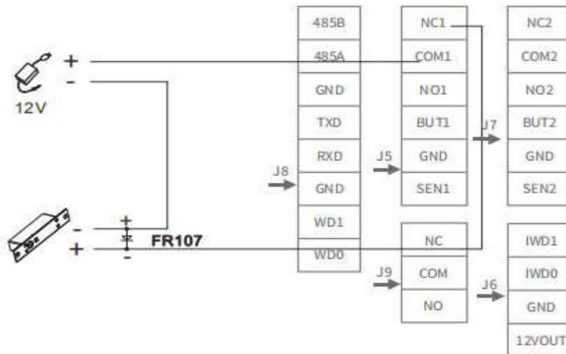
Чтобы избежать влияния ЭДС самоиндукции, создаваемой электрическим замком, на систему контроля доступа, параллельно замку должен быть подключен защитный диод FR107. Анод диода подключите к «-» электрического замка, а катод к «+» электрического замка. Подключите диод как можно ближе к электрическому замку.
