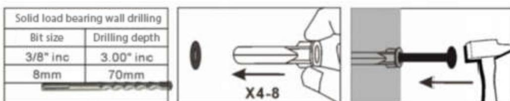
Шаг 5: Вбейте пластиковые дюбели или анкеры в просверленные отверстия, затем плотно зафиксируйте монтажную пластину шурупами.
