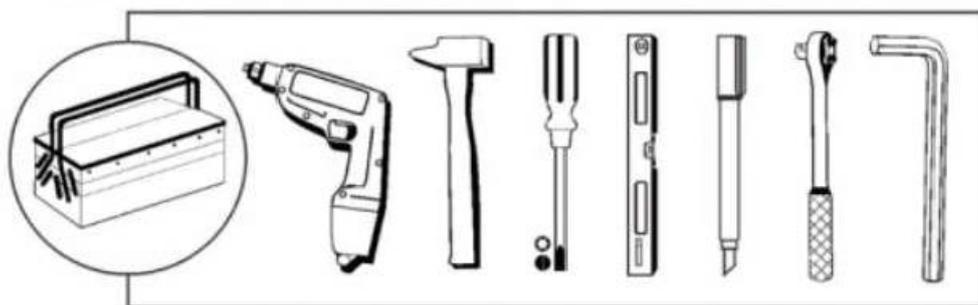
Перфоратор, молоток, шлицевая и крестовая отвертка, линейка, маркер, шестигранный ключ, трещетка
