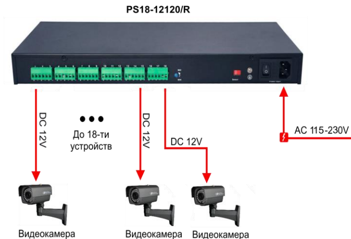
Рис.3 Типовая схема подключения блоков питания PS18-12120/R, PS18-12240/R на примере блока питания PS18-12120/R
