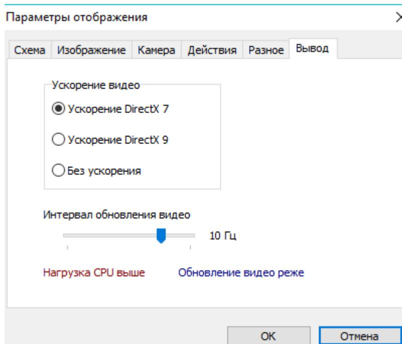
**Ускорение видео** – переключатель позволяет выбрать вариант используемого аппаратного ускорения.
