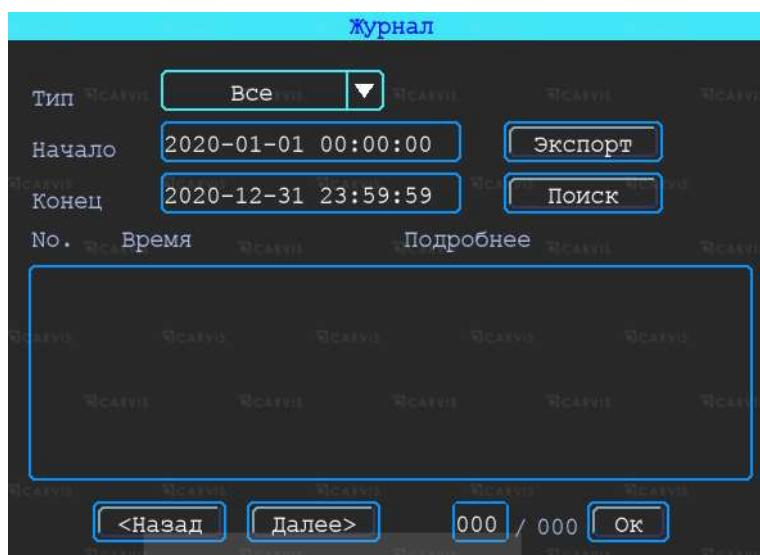
Доступны следующие значения: Все, Тревога, Исключения, Лок настройки, Удал настройки, Настройка 4G, G-сенсор, Система(флэш). Все события журнала кроме событий типа - Система(флэш) записываются на носитель данных (SD, HDD). События типа Система(флэш) записываются во внутреннюю энергонезависимую флэш память видеорегистратора. Доступны 250 записей (при переполнении записей старые записи перезаписываются на новые).
