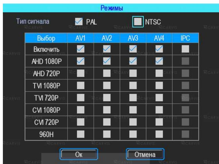
Видеорегистратор работает с AHD, TVI, CVI, IPC, разрешения 720P и 1080P, а также с аналоговыми камерами (960H). Для выбора нужной настройки, нужно поставить «Галку» в соответствующую строку. Переключение поканальное. Настройка регистратора зависит от типа используемых камер.
