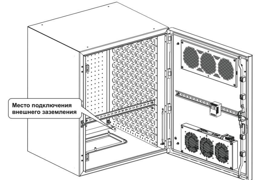
Конструкция шкафа предусматривает установку систем вентиляции: фильтра R-FAN-F, вентиляторных модулей R-FAN-x (ТУ РБ 800008148.004-2005).
