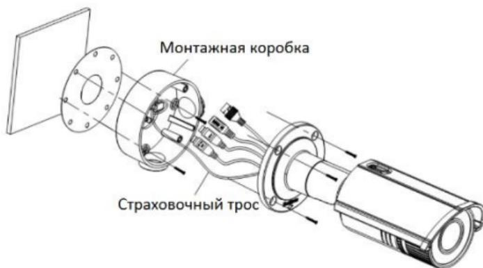
Рисунок 2-13 Установка с монтажной коробкой
