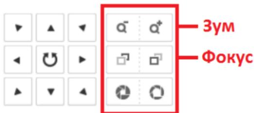
Рисунок 2-16 Регулировка зума/фокуса через веб-браузер
