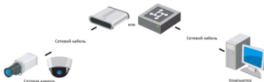
Рисунок 3-2 Подключение через коммутатор или роутер
