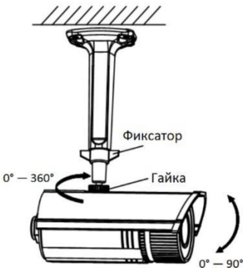
Рисунок 2-9 Настройка угла наблюдения
