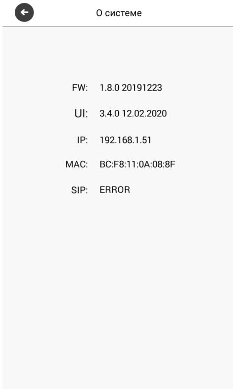
В данном окне отображается текущее состояние SIP подключения, текущий IP адрес, MAC-адрес и текущая версия прошивки.
