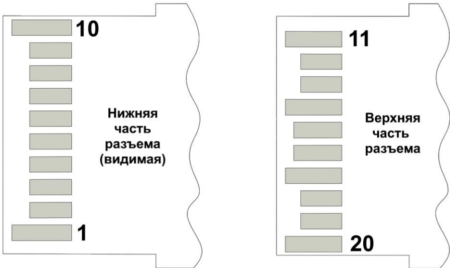
Рис. 3 Распиновка SFP+ разъема
