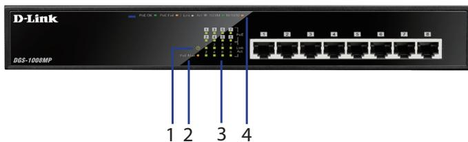
Рисунок 1: Индикаторы передней панели
