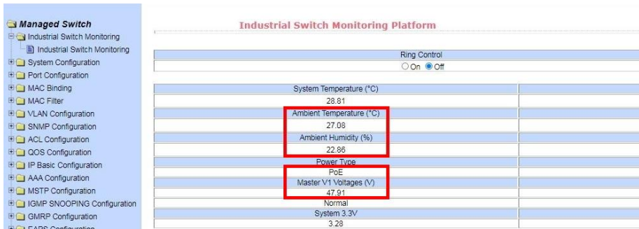
Рис.7 Контроль напряжения питания, параметров температуры/влажности окружающей среды через через Web-интерфейс коммутатора
