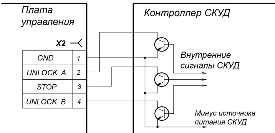
**Рисунок 13. Управляющий элемент – схема с открытым коллекторным выходом**
