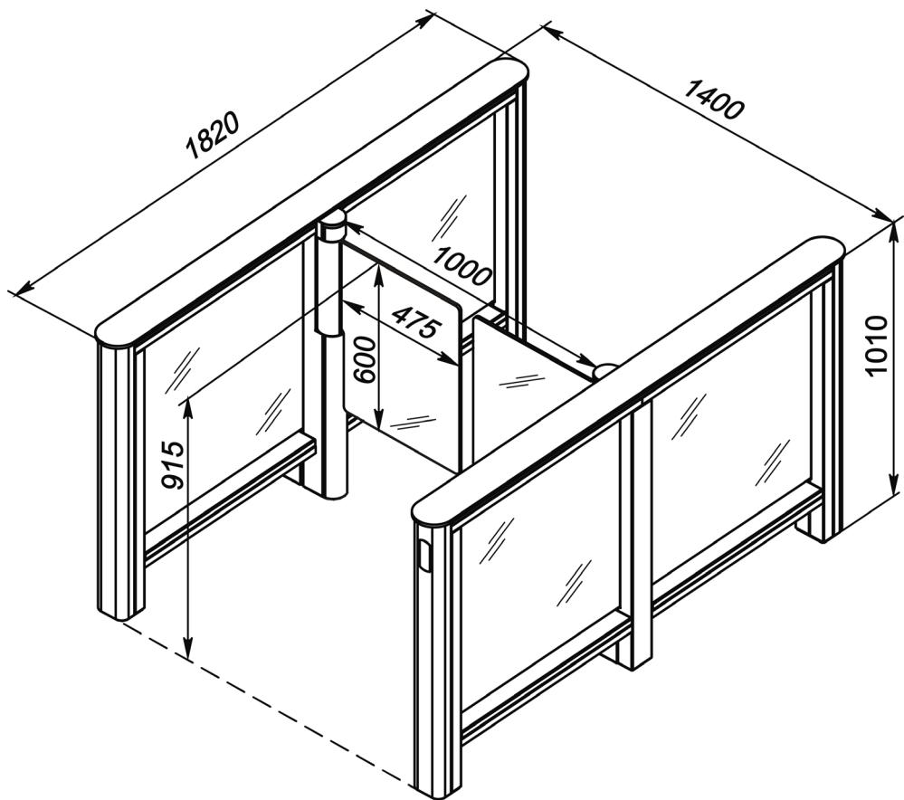
Рисунок 5. Габаритные размеры турникета со створками PERCo-ATG-475
