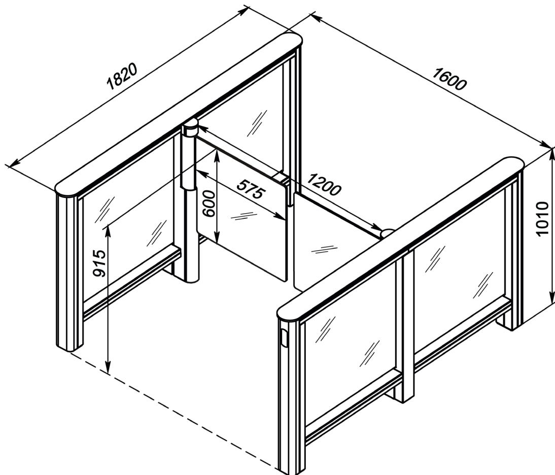
Рисунок 6. Габаритные размеры турникета со створками PERCo-ATG-575
