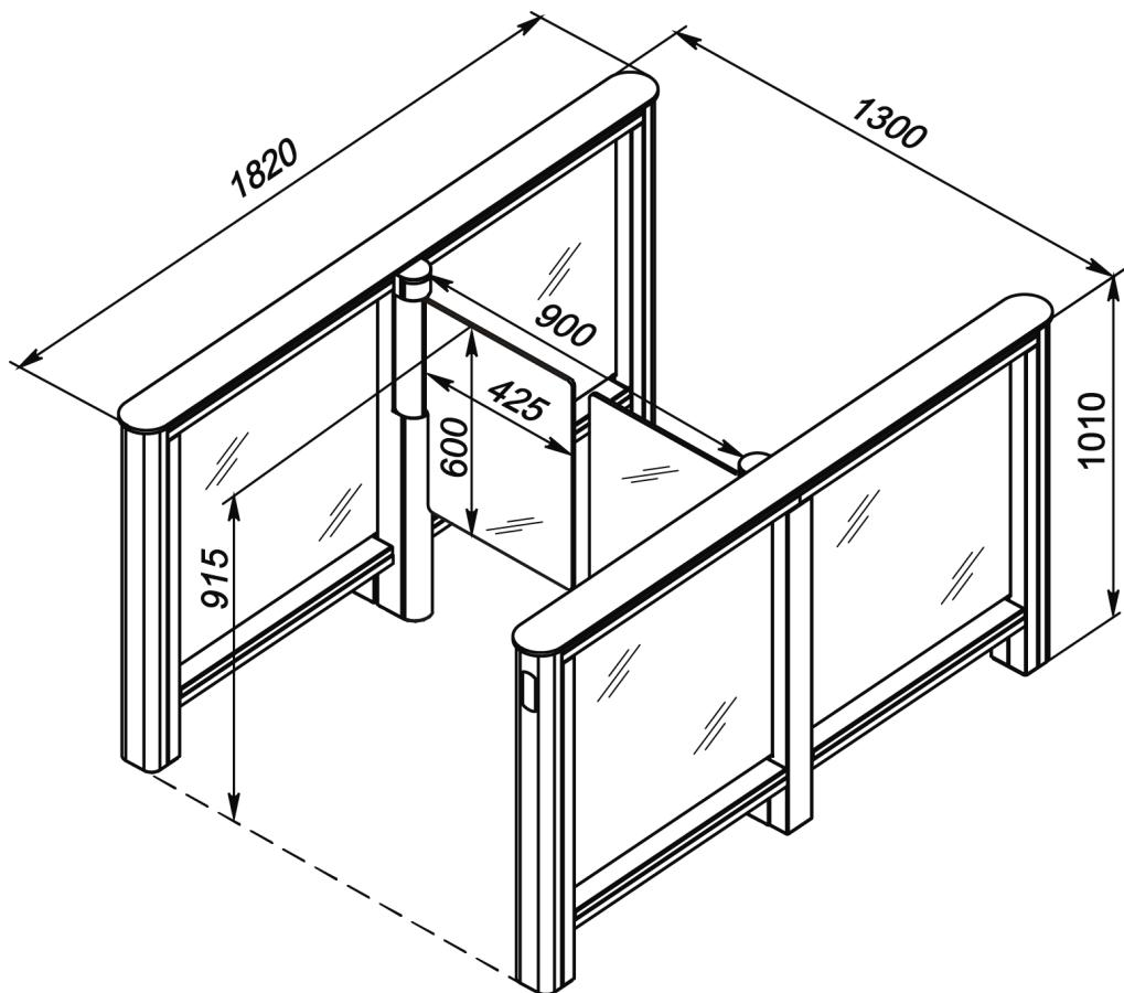
Рисунок 3. Габаритные размеры турникета со створками PERCo-ATG-425
