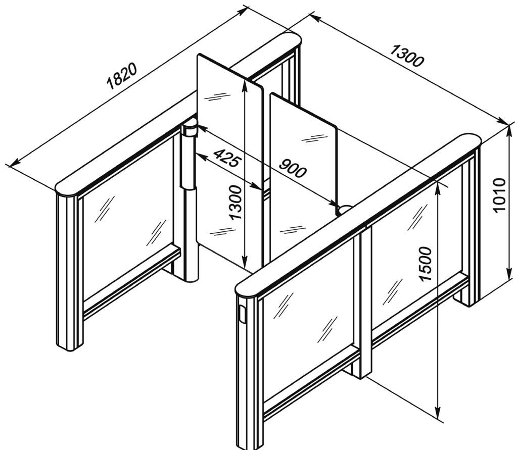
Рисунок 4. Габаритные размеры турникета со створками ATG-425H
