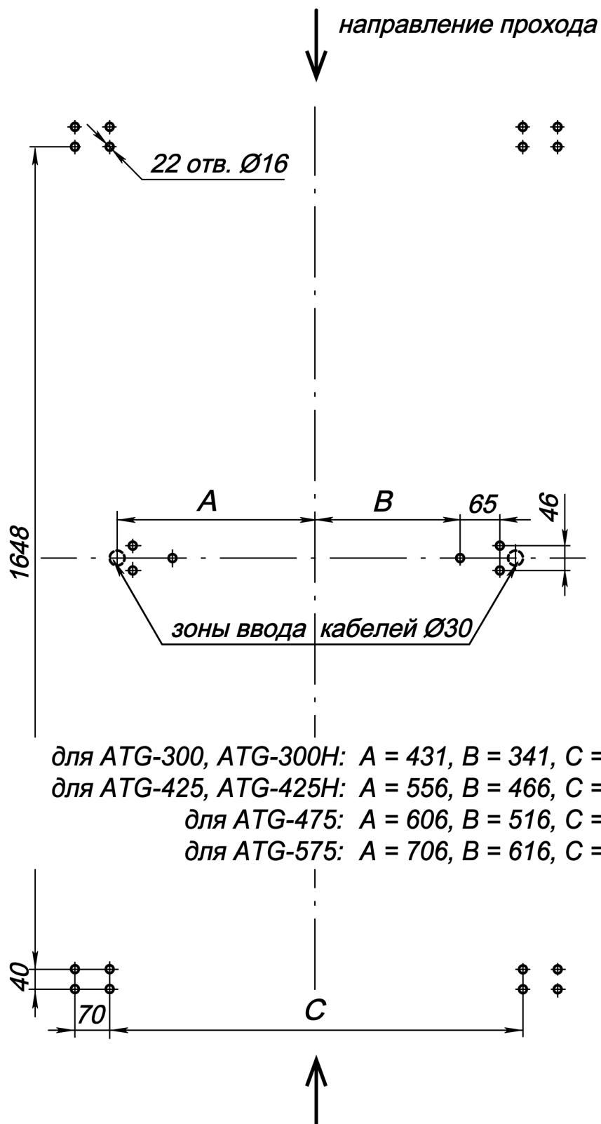
Рисунок 17. Схема разметки для монтажа турникета<sup>1</sup>
