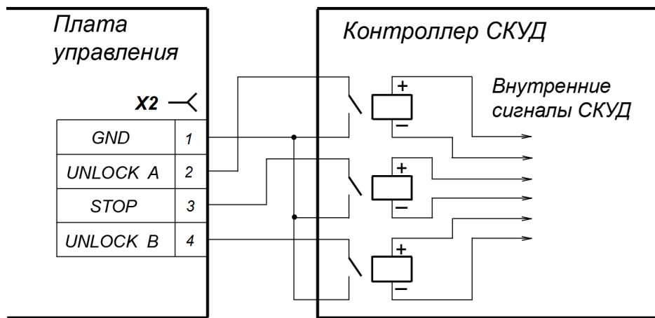
**Рисунок 12. Управляющий элемент – нормально разомкнутый контакт реле**
