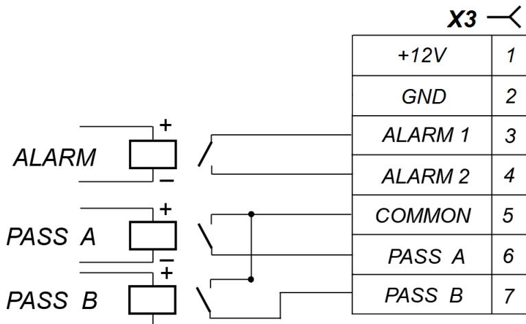
Рисунок 15. Выходные каскады для PASS A, PASS B и Alarm
