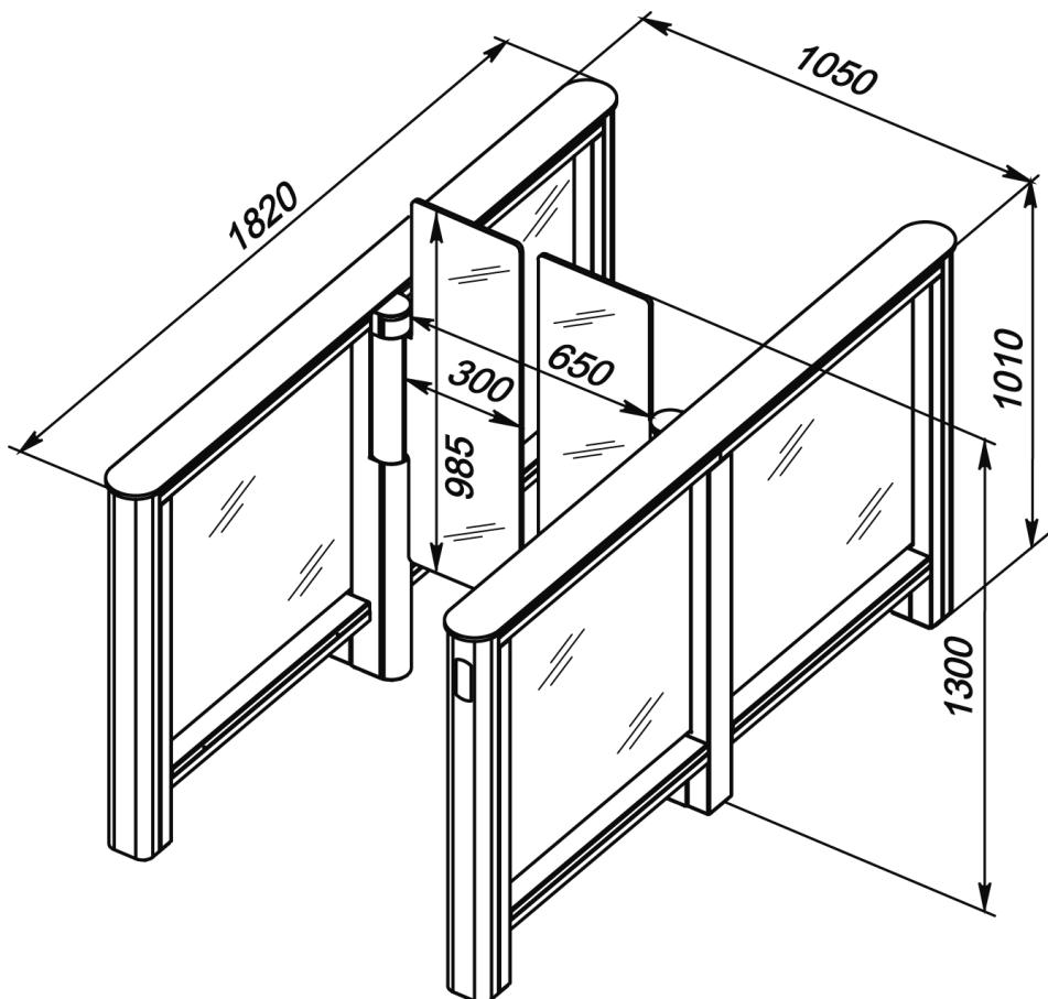
Рисунок 2. Габаритные размеры турникета со створками PERCo-ATG-300H
