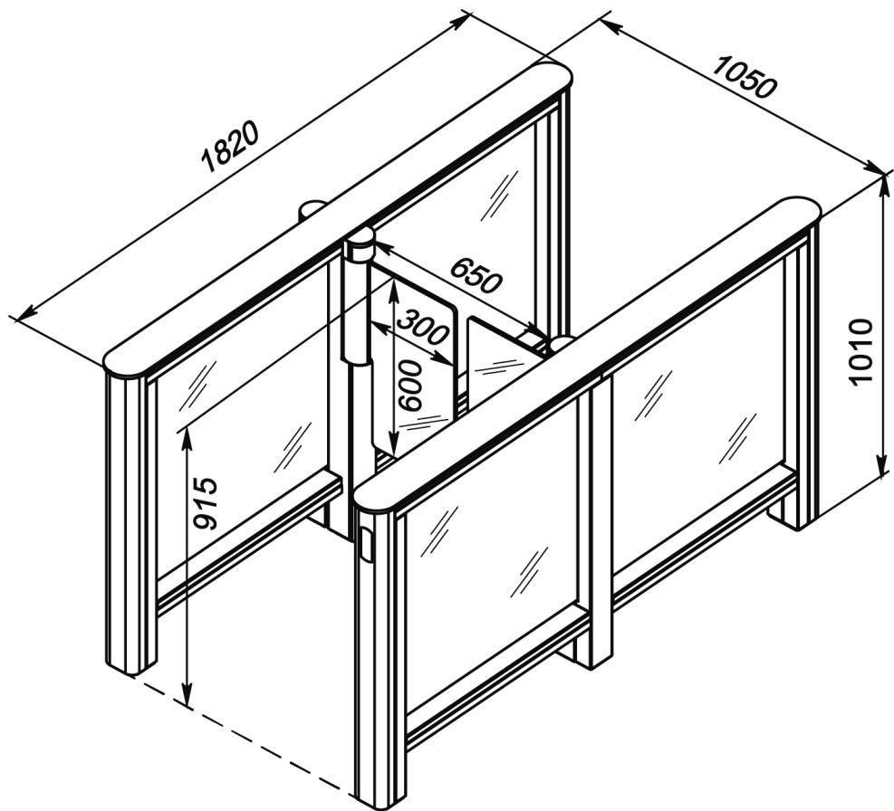
Рисунок 1. Габаритные размеры турникета со створками PERCo-ATG-300
