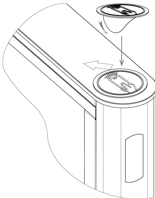
**Рисунок 27. Наклеивание резиновой накладки на стеклянную крышку**
