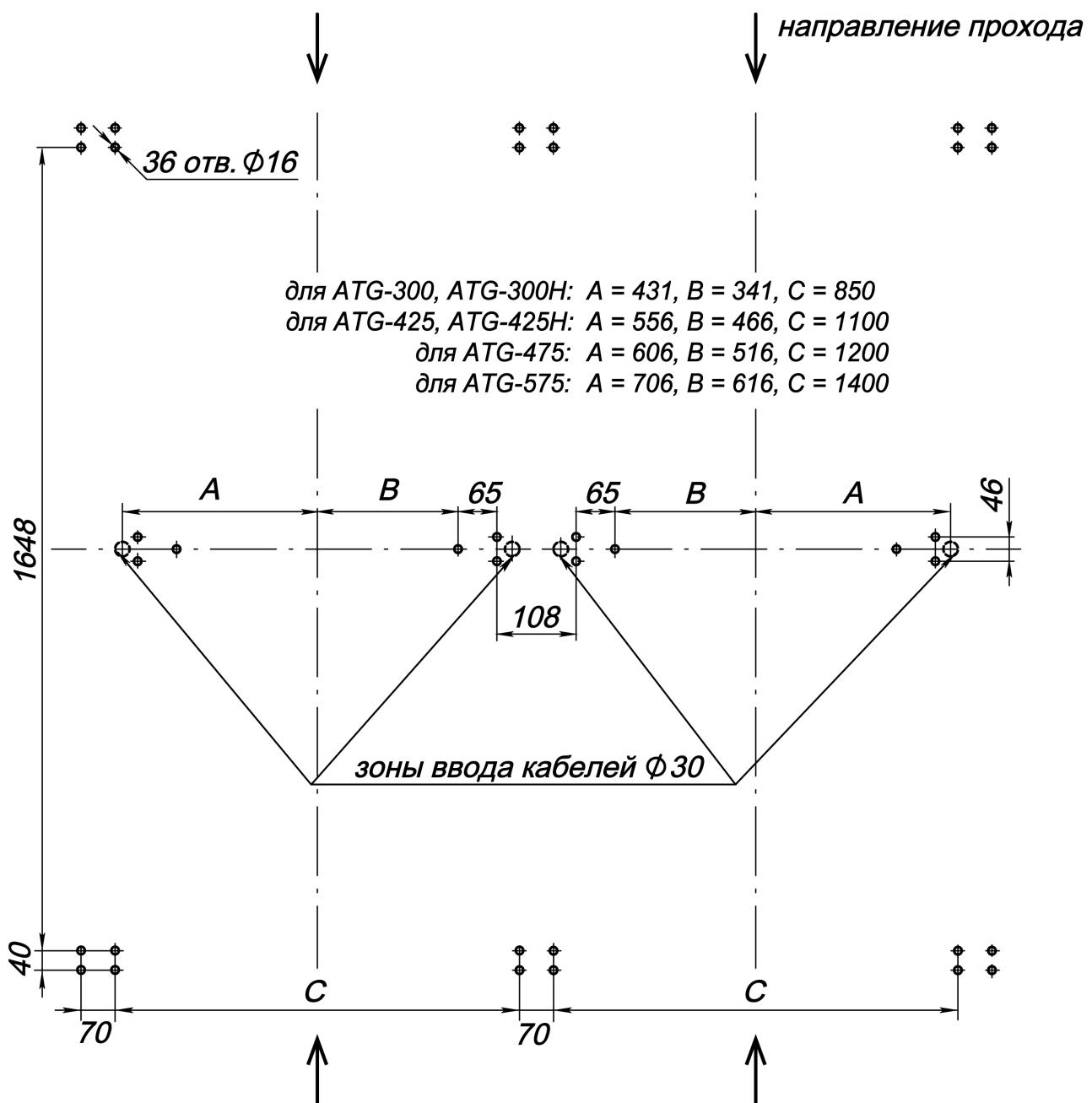
Рисунок 18. Схема разметки для монтажа турникета и двусторонней секции<sup>1</sup>
