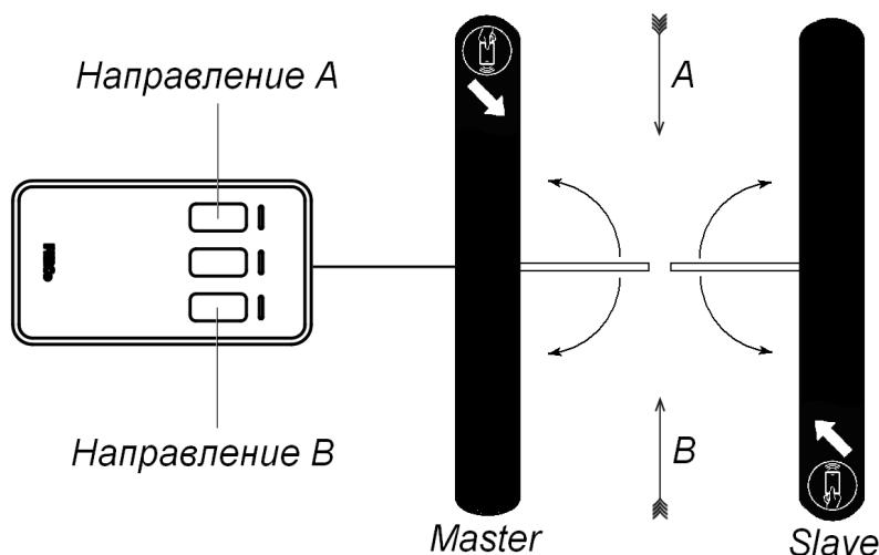
**Рисунок 14. Стандартная ориентация ПДУ относительно секций турникета**
