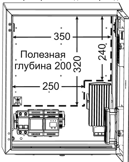
Рисунок 1 – Пространство внутри для установки доп. оборудования
