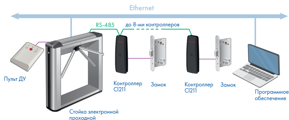
Структурная схема подключения электронной проходной
