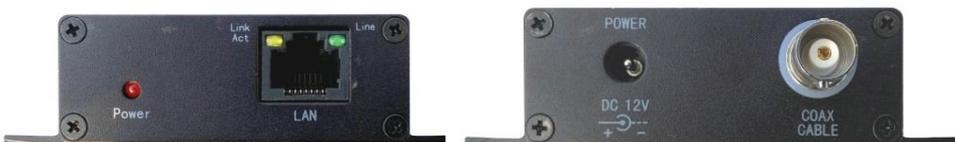
Рис. 2 Разъёмы и индикаторы приёмопередатчика TR-IP/1.
