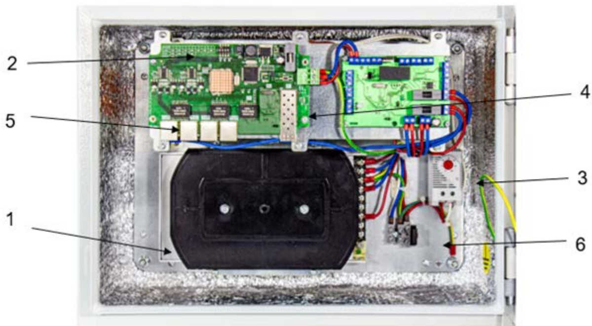
Рисунок 7. Расположение составных частей коммутатора
