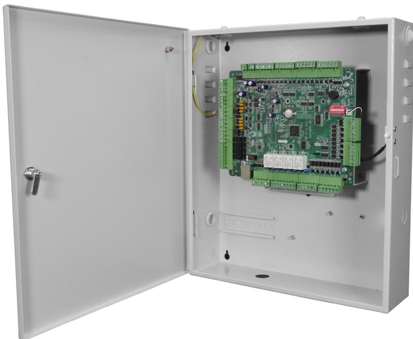
**TR-C481B** – сетевой контроллер на четыре точки прохода, поддерживает стек протоколов TCP/IP, подключение четырех считывателей по интерфейсу Wiegand и восьми по интерфейсу RS-485/OSDP, четырех кнопок выхода, четырех датчиков двери, поставляется в металлическом корпусе. Предусмотрено место под установку БП и АКБ (в комплект не входит), укомплектован DIN-рейкой для установки дополнительного оборудования.
