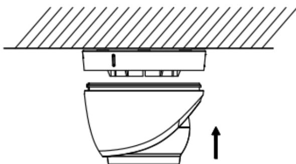
Рисунок 2-3 Закрепление камеры на крепежной подставке
