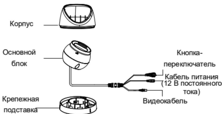
Рисунок 1-1 Обзор камеры типа I
