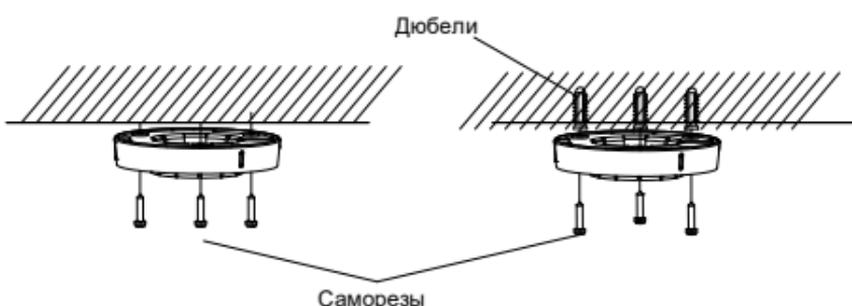
Рисунок 2-2 Прикрепление крепежной подставки к потолку
