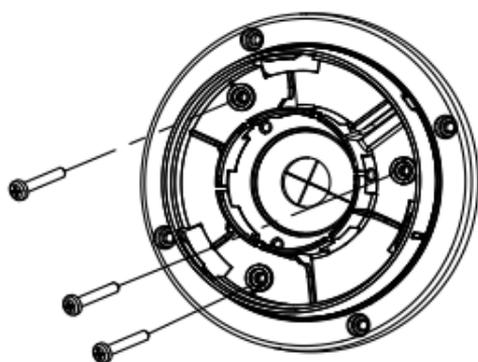
Рисунок 2-6 Установка крепежной подставки поворотной камеры
