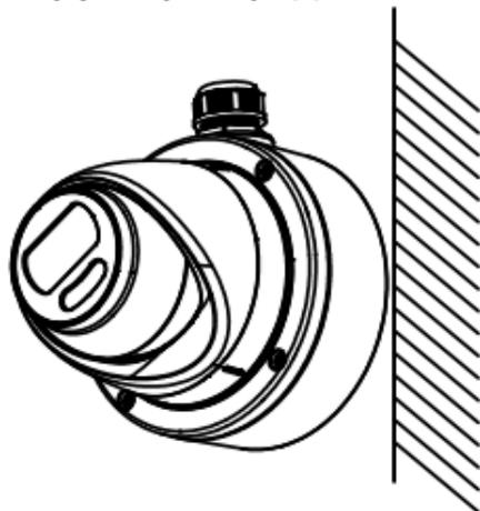
Рисунок 2-8 Закрепление камеры на распределительной коробке
