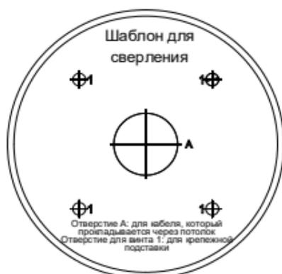
Рисунок 2-5 Шаблон для сверления для распределительной коробки
