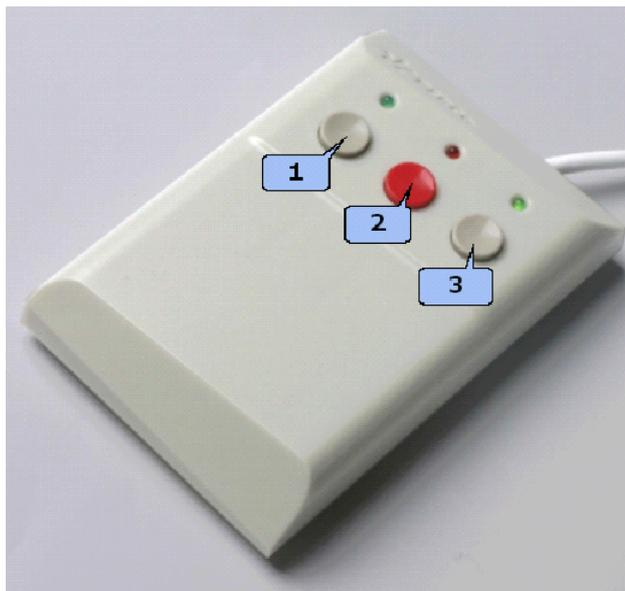
При поступлении запроса ПДУ издает звуковой сигнал, и начинает мигать световой индикатор над одной из кнопок. На экране монитора отображается информация о владельце предъявленной карты (в том числе фотография) из базы данных системы, а также кадры с камеры, указанной при конфигурации точки верификации.
