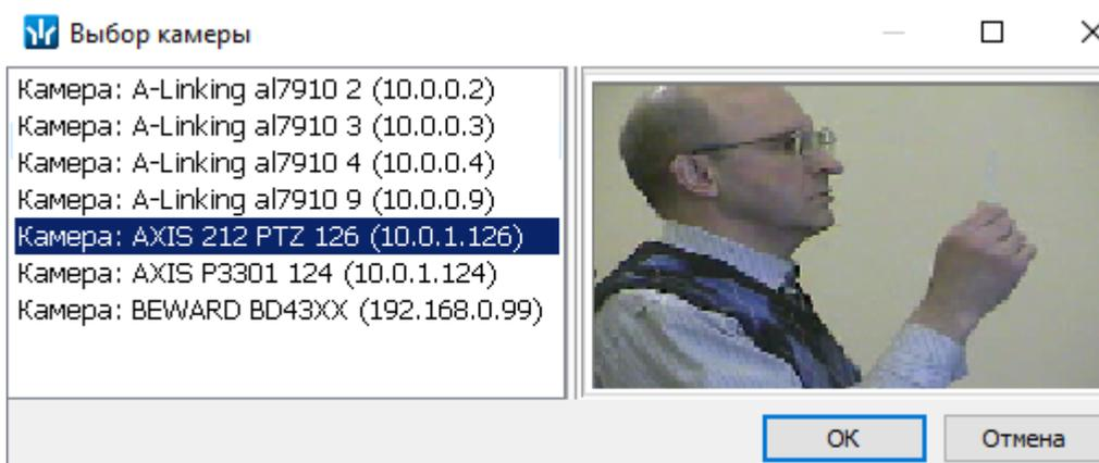
5. В открывшемся окне отобразится список всех камер, входящих в конфигурацию системы безопасности. В столбце **Камера** выделите камеру, которая будет использоваться для точки верификации. При этом в правой части окна будут транслироваться кадры с выбранной камеры. Нажмите кнопку **ОК**.
