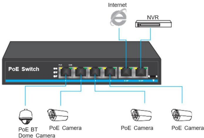
Рисунок 2 – Общая схема подключения устройств к коммутатору
