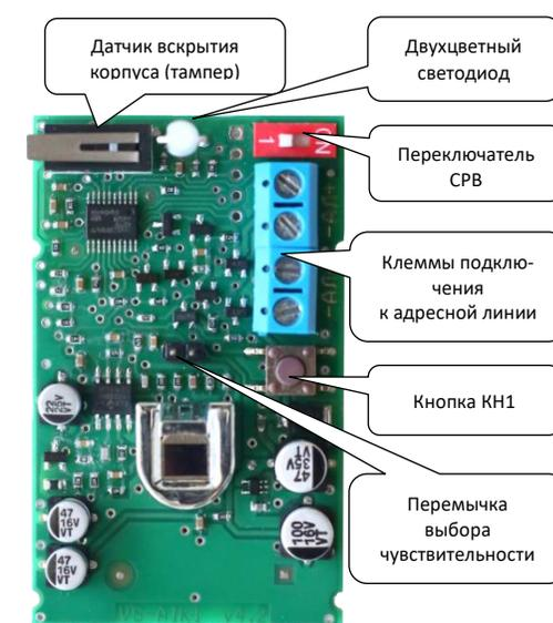
**Внимание! При проверке известателя кнопкой «КН1» кнопка «Тампер» должна быть зафиксирована в нажатом состоянии.**
