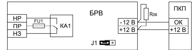
Рис.4 Схема подключения БРВ к выходу ОК ПКП, оконечный резистор отличен от 7,5 кОм
