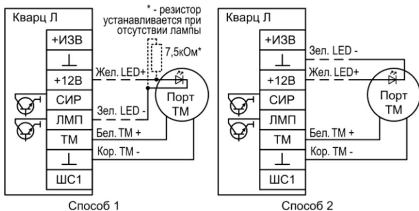
**Рис.А2** Схемы подключения порта ТМ
