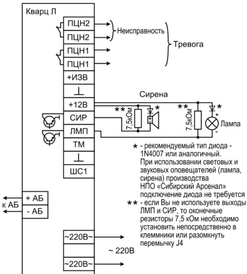
**Рис.А1** Схема внешних подключений
