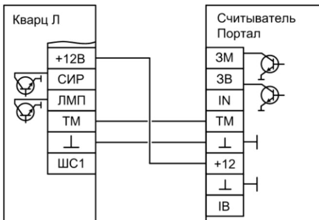
**Рис.А3** Схема подключения считывателя «Портал»
