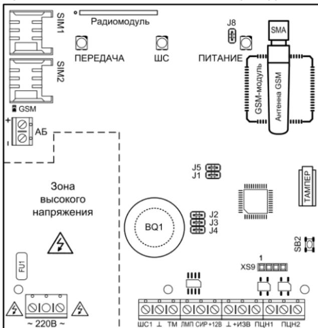
**Рис.1** Плата прибора (вариант с радиомодулем)
