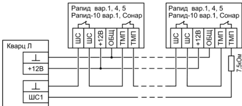
**Рис.А7** Схема подключения охранных извещателей Рапид вар.1,4,5, Рапид-10 вар.1, СОНАР
