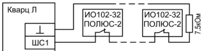
**Рис.А4** Схема подключения магнитоконтактных охранных извещателей ПОЛЮС-2
