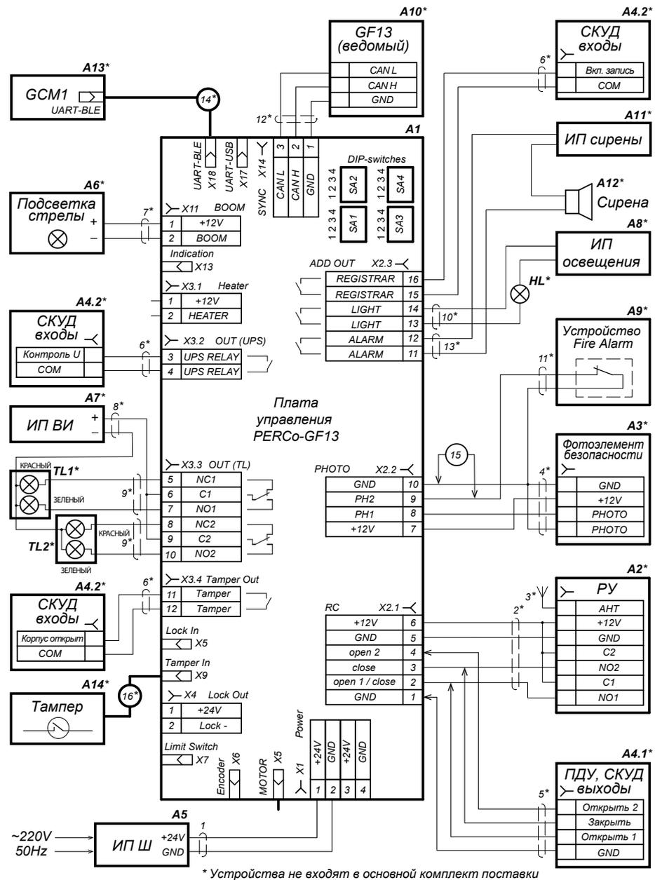
Схема электрических соединений шлагбаума GF13
