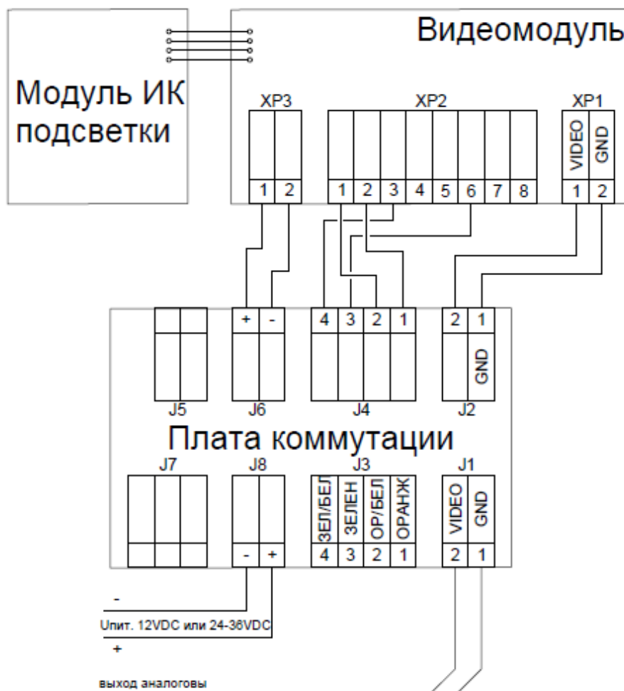
Рисунок 7.а. Схема подключения AHD видеокамер (Для исполнений AHD видеокамер без подогрева Упит. – 12VDC, для исполнений AHD видеокамер с подогревом Упит. – 12VDC или 24-36VDC)
