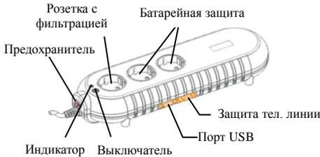
**Выключатель** – включение, выключение, тест ИБП, отключение звука
