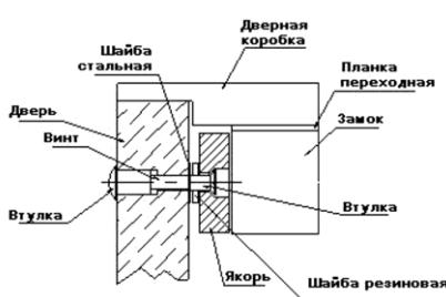
Сначала устанавливается накладка (крепёжная планка, - при поставке она идёт в сборе с замком), подводятся и подсоединяются провода, крепится сам замок. Затем на двери, напротив замка устанавливается якорь. Крепление якоря рассчитано таким образом, чтобы удерживать дверь под нагрузкой, на которую рассчитан электромагнитный замок. Для этого крепление может проходить через дверь насквозь и закрепляться с обратной стороны
