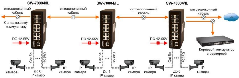
Рис.6 Типовая схема подключения коммутатора на примере SW-70804/IL
