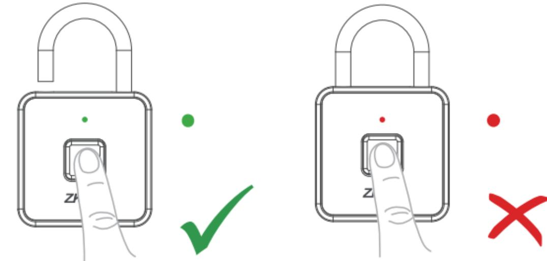
Нажмите зарегистрированным пальцем на датчике, зеленый светодиод загорится, если верификация прошла успешно, а затем замок разблокируется автоматически. Если горит красный светодиод, пожалуйста, нажмите пальцем правильно.
