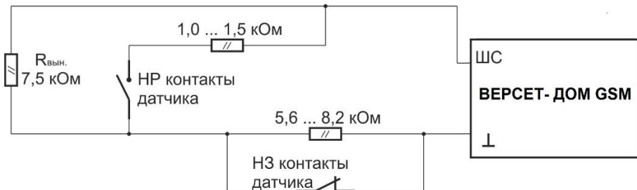
Рис.12. Схема включения технологических датчиков в ШСТ.
