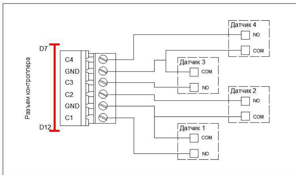
Контроллер поддерживает восемь внешних GPIO входов для подключения внешних датчиков. В качестве таких датчиков могут использоваться антikражные, антивандальные и т.п. устройства имеющие нормально открытый «сухой контакт» или уровень логического нуля при срабатывании. При изменении сигнала на GPIO входах, в ПО TRASSIR формируется событие «сигнал на входе появился/пропал».
