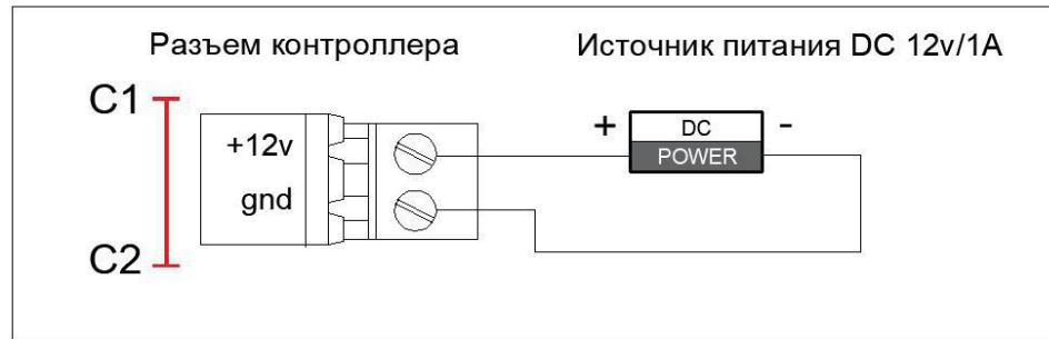
В качестве источника резервного питания к устройству можно подключить внешний аккумулятор (DC 12 v). При этом сам контроллер осуществляет контроль зарядки АКБ при питании от сети.
