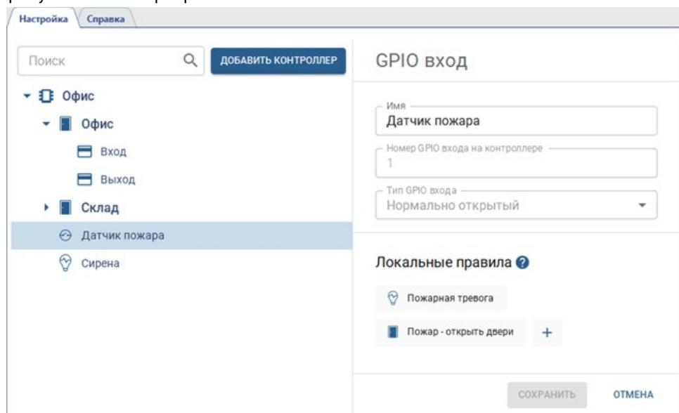
Например, при замыкании сигнала с пожарной сигнализации на одном из тревожных входов возможно установить режим "всегда открыто" для точек доступа этого контроллера и замкнуть один из тревожных выходов для включения сирены.
