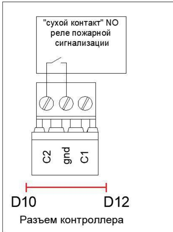
Для автоматической разблокировки замков дверей (турникетов) в случае возникновения пожарной тревоги, "нормально открытый" (NO) контакт реле интерфейса пожарной сигнализации подключить к контактам С-GND любого GPIO входа платы контроллера (C1-C8).
