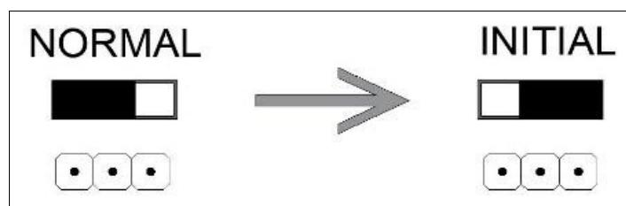
2. Отключите электропитание и подключите снова. Контроллер перезапустится, а зуммер издаст длительный звуковой сигнал.
