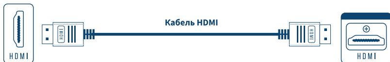
Подключение кабеля должно производиться при выключенном питании интерактивной панели.
